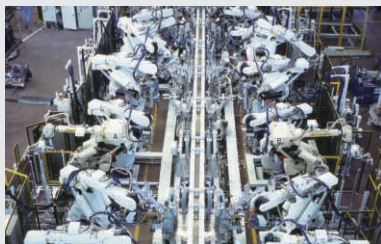
▲組立溶接設備
