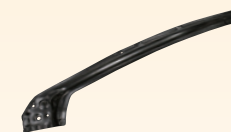
2023年 1470MPa 冷間超ハイトン材 加工のフロントピラー
