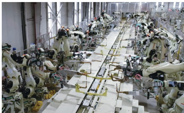
組立溶接設備
