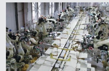
組立溶接設備
