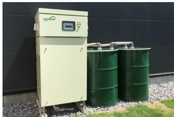
「CO<sub>2</sub>貯留・供給装置」
